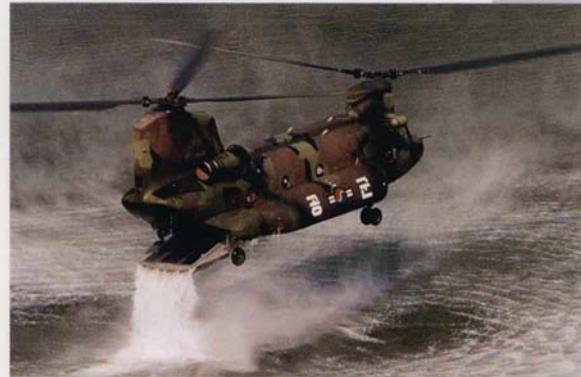
Chinook기의 특성을 살펴보면 전·후방 로터 계통('Tandem Rotor Sys')으로 전방-반시계, 후방-시계 방향으로 회전하고 Cabin 도어는 비행중 개방 가능한 우측 및 후방 램프에 각각 위치하고 있으며, 수상 착수 가능토록 칸막이(Water Dam)가 제작되어 있으며, 착륙 장치는 임무 수행에 용이한 4개의 Non-retractable형으로 되어 있다.
