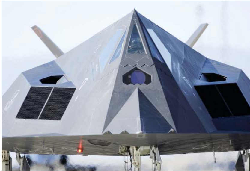
정렬된 기체 경사각과 공기 흡입구 전파흡수망 스텔스 설계를 확인할 수 있는 F-117 정면
