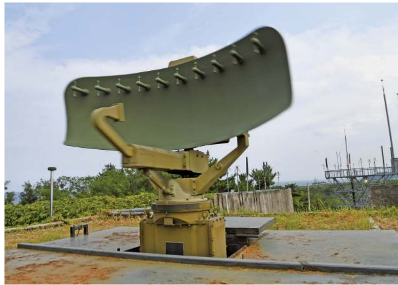
작동 중인 저고도 탐지 레이더. 레이더는 유사시에 전개할 수 있도록 이동형으로 제작되었다.
