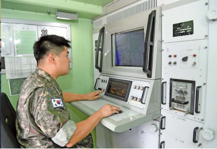
이재형 상사가 감시장비를 조작하고 있다. 피아식별을 위해 정해진 암호 및 코드를 정해진 시간마다 레이더 장비에 입력해줘야 한다.
