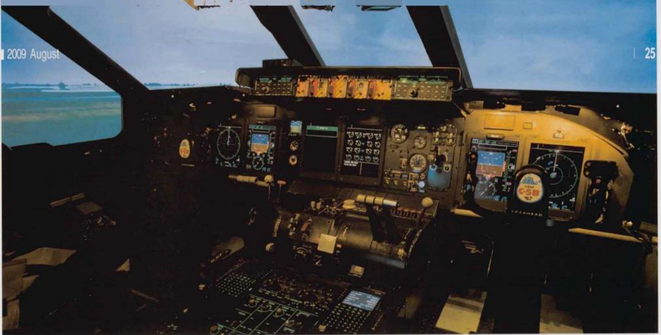
C-5 갤럭시 항전 현대화 프로그램의 최초 단계. 이를 통해 최신 통신, 내비게이션, 감시 및 항공통제 관리 성능을 장착함으로써 기존의 아날로그 항전을 현대화된 디지털 디스플레이로 교체하게 된다.
