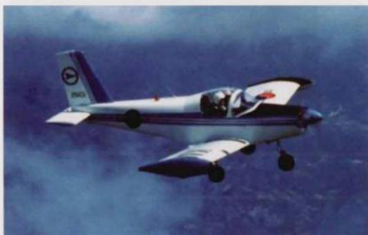
Pazmany Aircraft Corporation사의 PL-2 복좌형 비행기 설계를 빌려온 새매호는 3륜의 고정형 바퀴다리에 모노코크 구조(monocoque : 항공기 외판만으로 하중을 견디도록 한 형태)의 저익형 금속제 단엽기로서 우리 공군의 기술진에 의해 약 70%에 달하는 국산화율을 달성하였으며 시제기를 포함 총 4대가 제작되어 특수임무요원에 대한 훈련기로 활용하였다. 새매호는 부품조달의 애로점과 항공기 노후 등으로 1996년 1월 퇴역하였다. ㉞
