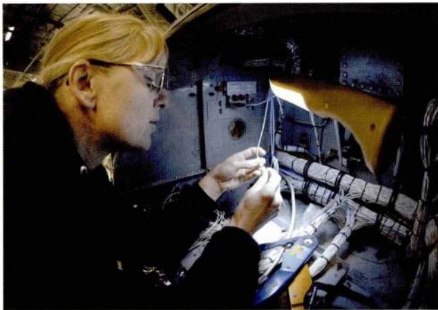
Catherine Knaus가 A-10 Thunderbolt II 내부 전선에 연결되는 데이터버스 접속장치를 배열하고 있다. A-10 정비사들은 A-10의 전선체계에서만 2,167개의 연결성 확인 및 1,200개의 장치 확인을 한다.
