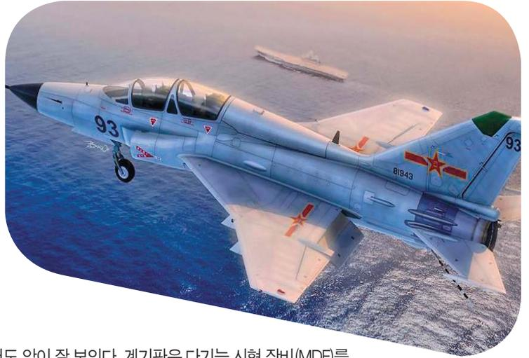
조종실은 처음부터 앞좌석과 뒷좌석에 큰 단차를 만들어 후방석에서도 앞이 잘 보인다. 계기판은 다기능 시현 장비(MDF)를 이용한 글래스 콕핏(Glass Cockpit)이 채택되어 사용 환경이 훨씬 향상됨은 물론, 최신예기 적응에도 유리해졌다. 조종간에서 손을 뗄 필요 없이 무장이나 장비를 제어하는 일체형 조종간(HOTAS)도 포함되어 신예기라는 이름값을 하고 있다. 전방석에서 조작한 제어 정보는 후방석의 MDF에도 표시되어 교관이 생도의 조종을 파악하고 감독하는 것이 가능하다.
