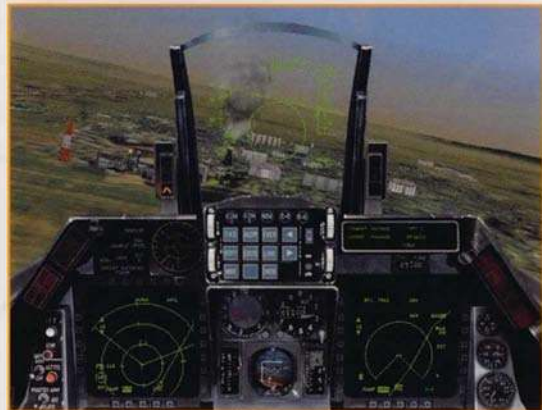
실제와 동일하게 작동되는 스위치와 항법 지도(위) HUD(Head Up Display)와 각종 계기판(아래)
