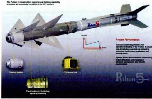
를 가진 새로운 관성 항법 장치를 구비하고 있다. 이 FOG IMU는 중간궤도 유도를 제공하여 미사일에 새로운 Lock-On After Launch capability(LOAL : 발사 후 표적 지속 추적 능력)를 제공하여, 비행자세 전환 없이 발사가 가능하다. 미사일의 INS(Inertial Navigation System : 관성항법장치)에 표적 자료를 보냄으로 Python 5는 자율적인 표적 탐색을 시작하는 시점인 탐색기의 탐색 한계치 이상의 거리에서 발사될 수 있다.
