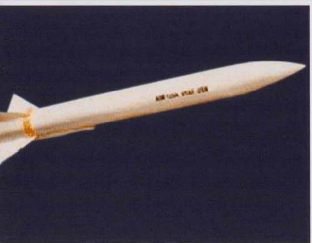
· 능동 유도(레이더 추적) 미사일 : 열추적 미사일의 장점인 『발사 후 즉시 이탈(fire & forget)』 기능은 유지하고, 반능동 미사일처럼 원거리 공격이 가능한 것이 능동유도 방식이다. 미사일 자체에 레이더를 탑재하여 레이더 신호를 송신하고, 목표물에 반사되어 돌아오는 신호를 수신함으로써 최종접근 시까지 미사일이 직접 추적할 수 있다. 이 미사일은 과거 가시거리 내에서 벌어지던 공중전 형태를 가시거리 외곽(BVR : Beyond Visual Range) 형태 전술로 변형시켰고, 가시거리 밖에서 여러 대의 적기를 추적하며 다량의 미사일을 동시에 발
