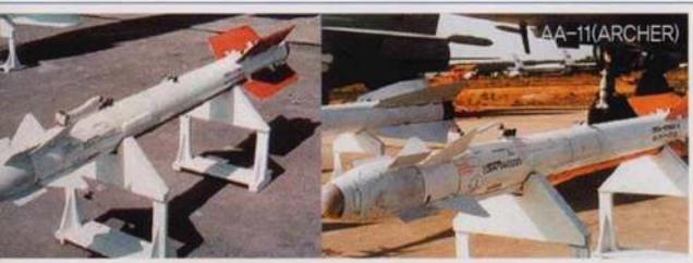
전방공격 능력을 보완하기 위하여 항공기 장착 레이더와 연동하여 유도되도록 하는 방식을 적용한 미사일이 반능동(Semi-active) 추적 미사일이다. 레이더로 목표물을 포착하여 미사일을 발사하면 발사된 미사일의 추적장치는 목표물로부터 반사되어 오는 레이더파를 추적해 목표물에 접근시킨다. 대표적인 해당 무기체계는 AIM-7(Sparrow) 계열과 프랑스의 Super 530, 이탈리아의 Aspide 등이 있다.
